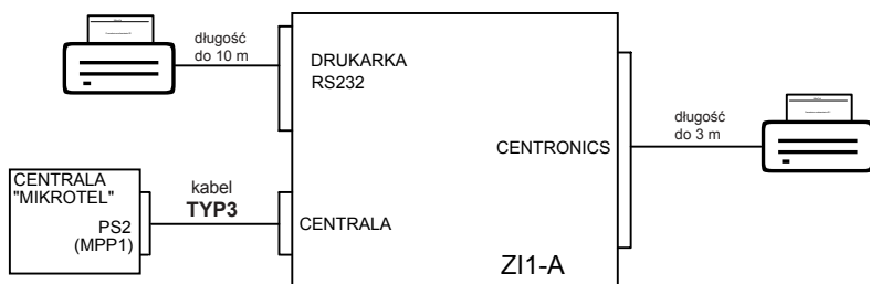
Rys. 6. Schematyczna prezentacja możliwości wykorzystania zdalnego interfejsu Z11-A przy pracy normalnej.
